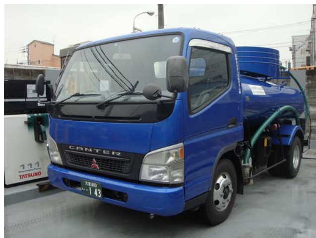
4トバキューム車 (シアン運搬専用車)
